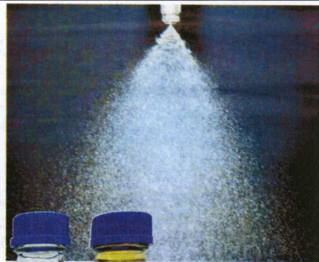
GAMBAR menunjukkan ujikaji semburan bahan untuk mengukur saiz titisan.
